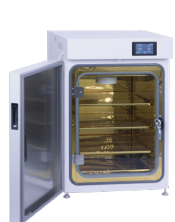
Herocell 180CC 二氧化碳培养箱 (铜内胆) 继承Herocell 180同等参数。304不锈钢 镀铜表面处理内胆腔室，可有效抑制细 菌滋生。
