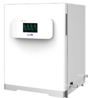
CellX 170MG 三气培养箱 六面直热温度均一性 \pm 0.3^{\circ}\text{C} (at 37^{\circ}\text{C} )； 180 ^{\circ}\text{C} 干热高温灭菌；CO 2 控制范围 0~20%；O 2 控制范围1~21%。
