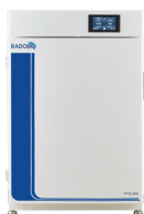
HC 180 医用二氧化碳培养箱 六面直热温场均匀性 \pm 0.2^{\circ}\text{C} (at 37^{\circ}\text{C} )； CO 2 浓度控制 (IR传感器)；140 ^{\circ}\text{C} 高温干热 灭菌。开门30s温度恢复时间是 \leq 4\text{min} 。
