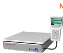
Unishaker 70 耐二氧化碳摇床 磁驱无皮带；转速范围20~350rpm (12.5mm振幅) 20~330rpm (25mm振 幅) 20~250rpm (50mm振幅)；分离式 的控制器部件。
